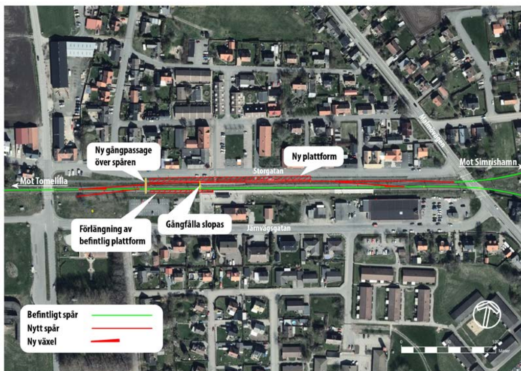
Figur 5 Principutformning av stationen i Gärsnäs
